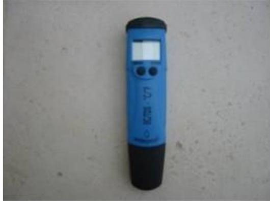
**Conductimètre portable pour mesure de la conductivité électrique des sols**
