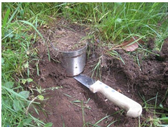
**Prélèvement au cylindre pour mesurer la densité apparente**
