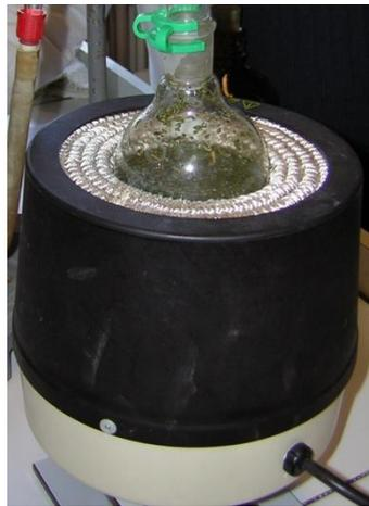
**Chauffe ballon utilisé au cours du protocole de dosage du carbone organique
