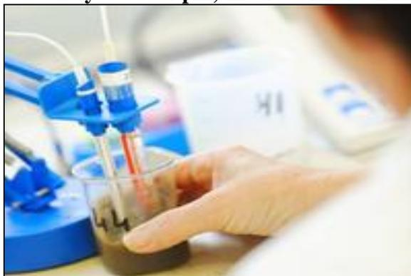
**Mesure du pH par la méthode électrométrique**
