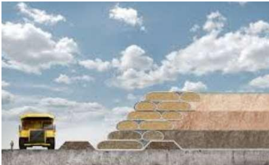
Figure 14 : Construction de digues et remblais
