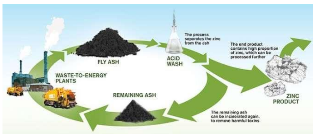
Figure 32 : Schéma illustratif de la méthode de lixiviation
