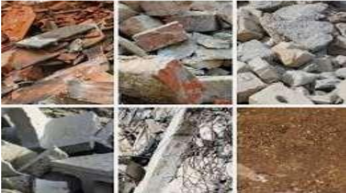
Figure 3: Gravats de matériaux inertes utilisés comme remblaiement
