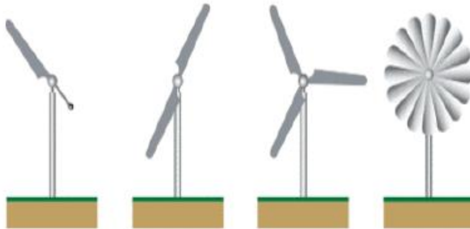
Figure I.11: Classification des éoliennes à axe horizontal selon le nombre de pales.
