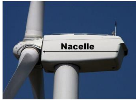
Figure I.8 : La nacelle d'une éolienne à axe horizontal.
