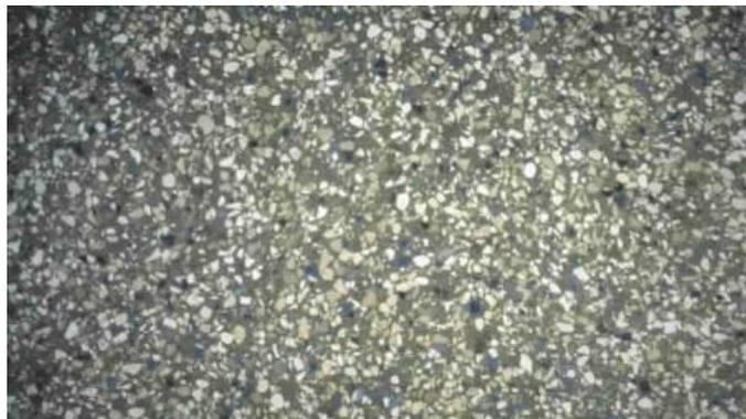
Figure I. 13 béton fibrés à ultra-hautes performances [29].
