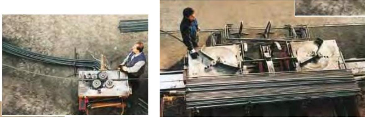
Figure III.14 Le façonnage à froid des armatures [18]
