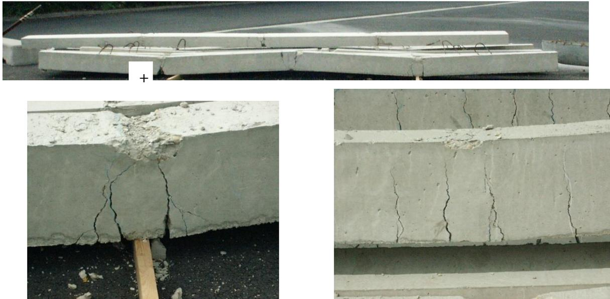
Figure III.6 La présence des fissures dans les éléments en Béton [17]
