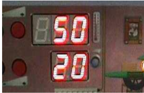
Figure (3.6) : L'afficheur 7 segments
