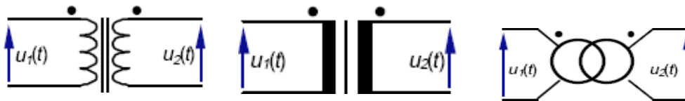
Figure (2.5) : Symbole électrique d'un transformateur
