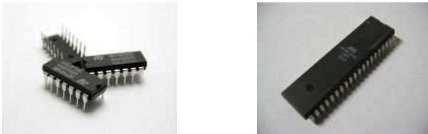
Figure (1.20) : circuit intégré CI
