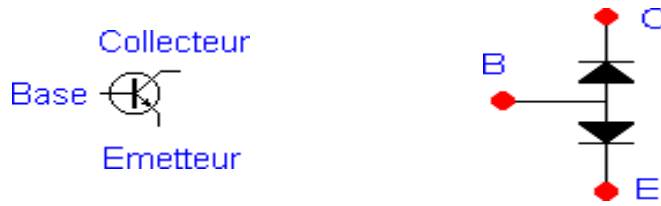
Figure (1.11) : Symbole électrique d'un transistor NPN
