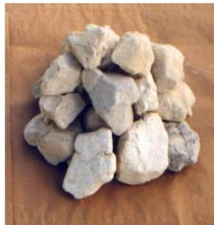
Fig. 12 : Pierres de calcaires et Morceaux de la chaux vive.
