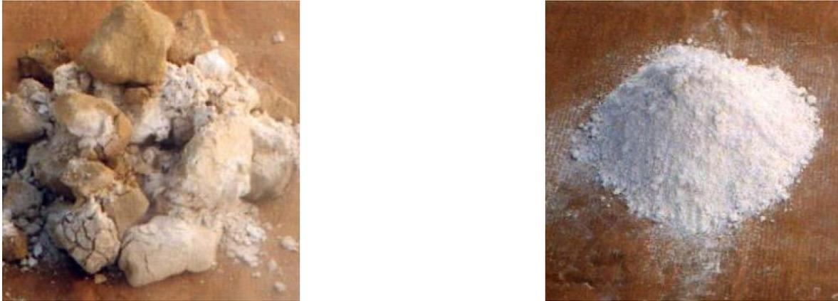
**Fig. 13 :** Morceaux de chaux vive aspergés à l'eau et Poudre de la chaux éteinte.
