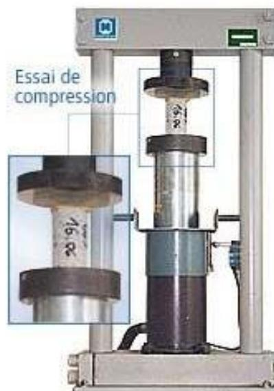
**Fig. 23 :** Essai de compression sur une éprouvette cylindrique du béton.
