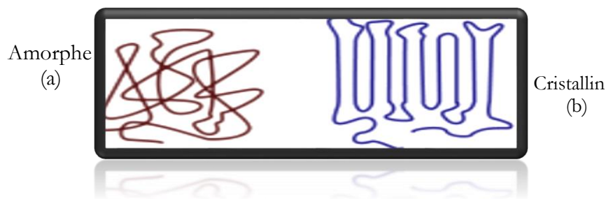
Fig. I.12 : Schéma présentant la disposition des chaînes macromoléculaires dans les domaines amorphes et cristallins.
