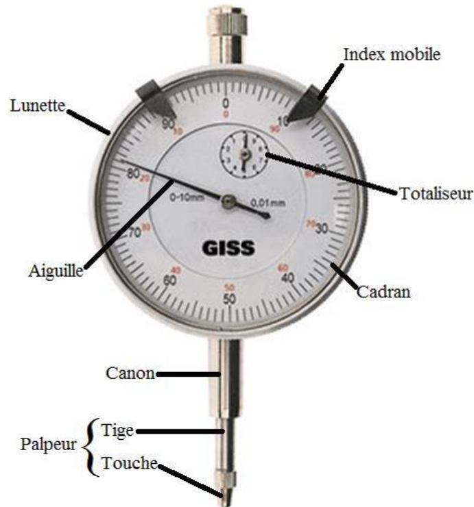
Figure 4.18. Comparateur à cadran
