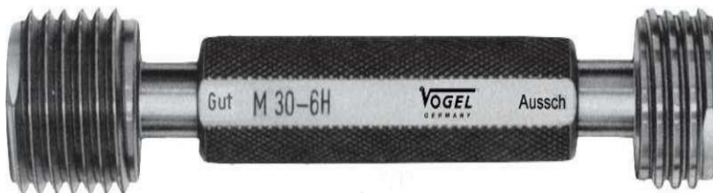
Figure 4.26. Tampon fileté double
