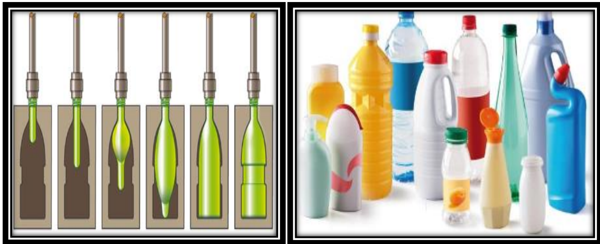
Figure I.7: Extrusion soufflage avec quelques exemples.
