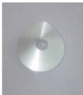
**Figure VI.09 :** Photo de la forme finale de la came après réalisation
