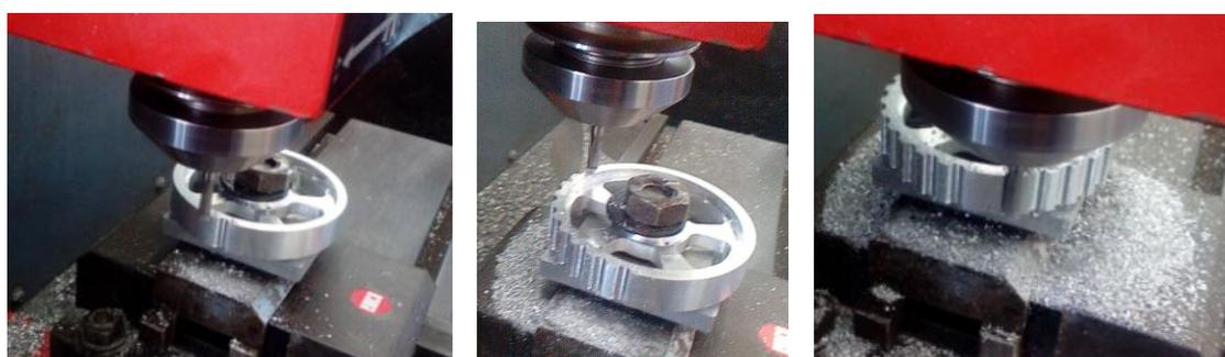
**Figure VI.14 : Etape d'usinage des dents du pignon à chaîne**
