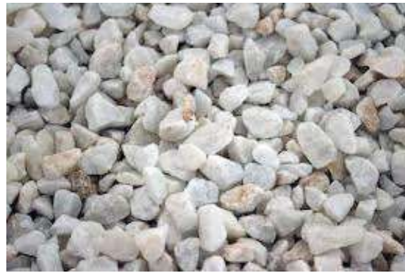
Figure 2.2 : Granulats concassés (de carrières).
