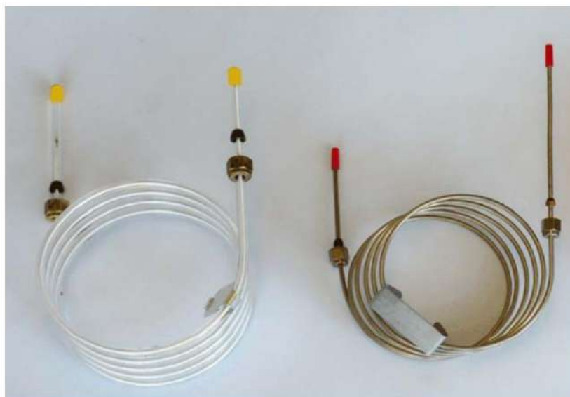
Figure 31 : Colonnes remplies pour la chromatographie en phase gazeuse.
