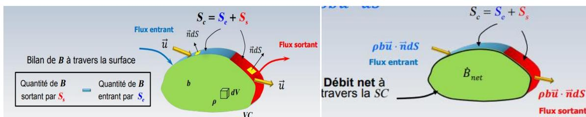
Le débit  $\rho b \mathbf{v}_r \cdot \vec{n} dS$  traversant la surface d'un volume de contrôle, correspond à la quantité de B qui "s'accumule" (négative ou positive) par unité de temps dans le volume de contrôle. Cette variation de B dans le volume de contrôle peut s'écrire:
