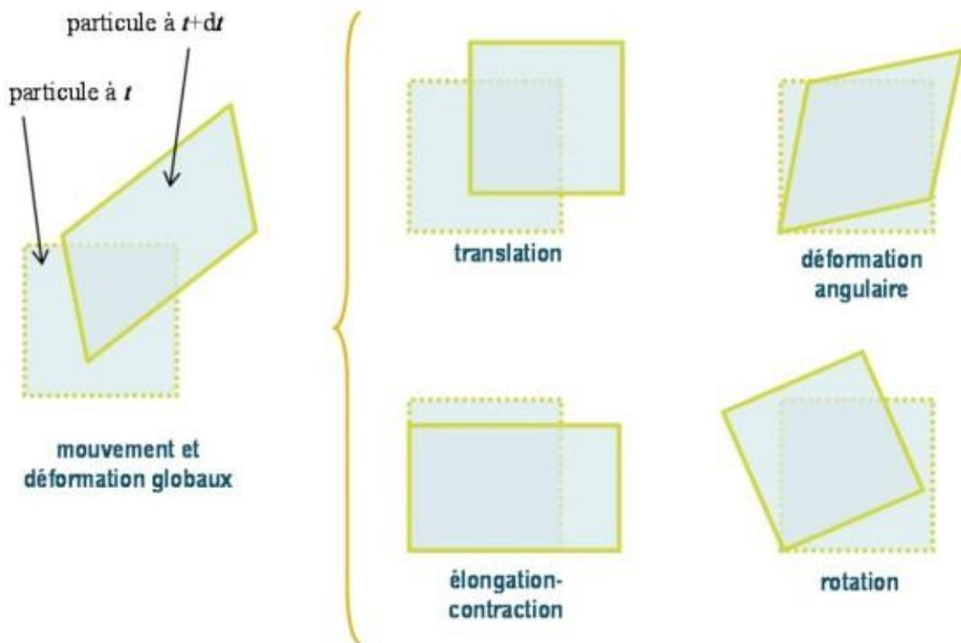
Fig.II.6 déformation lors d'un écoulement
