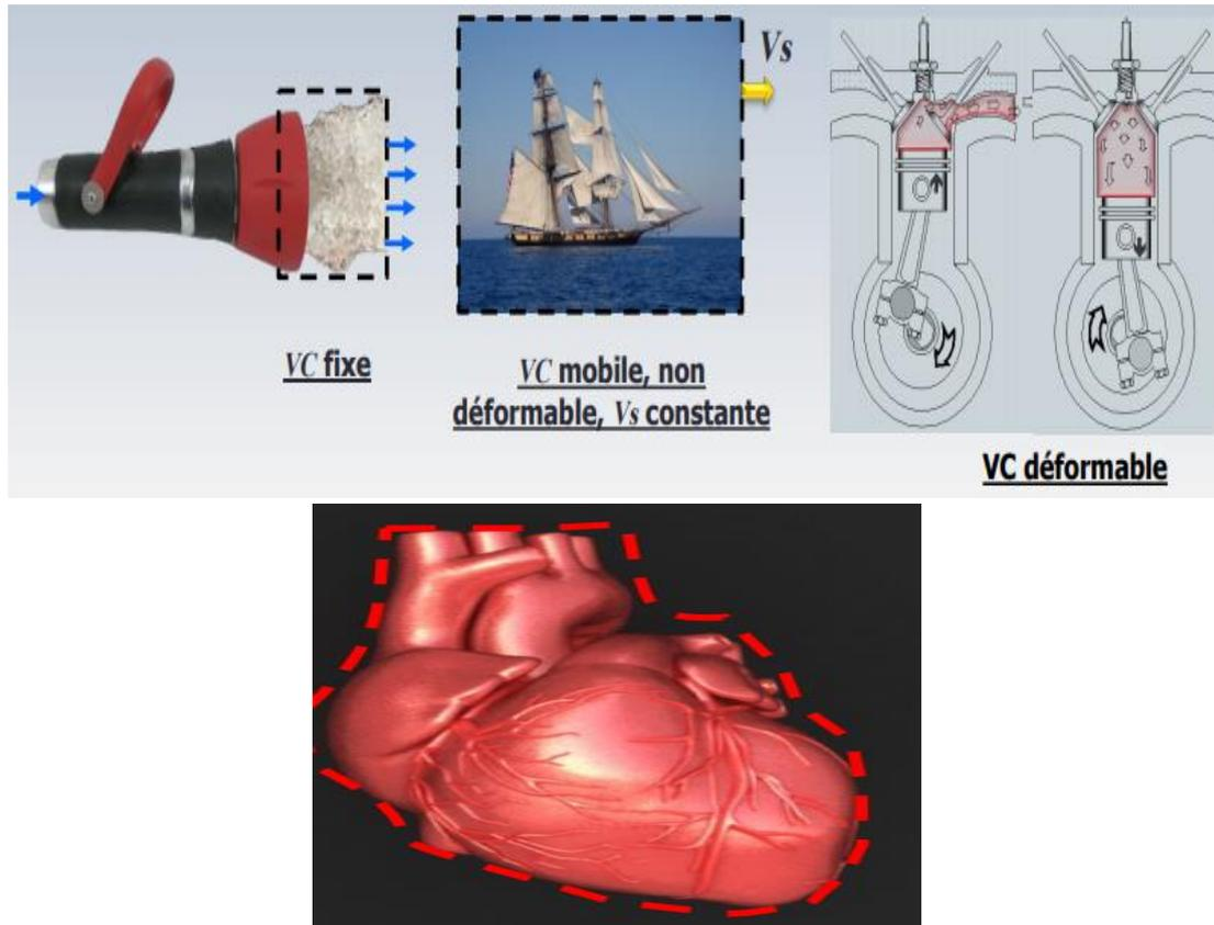
En mécanique de fluides, on propose de trouver la solution dans un système fermé mobile (VM) au moyen d'une seconde approche représentée par un système ouvert (VC). Le système fermé (VM) est associé à la cinématique Lagrangienne, tandis que le système ouvert (VC) à l'approche Eulérienne.
