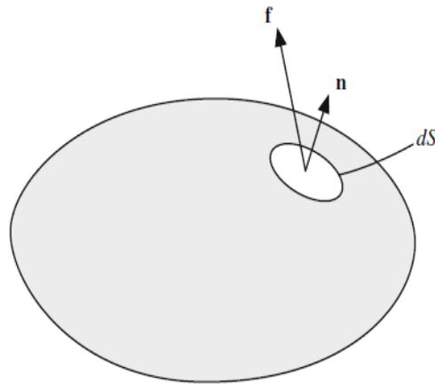
Fig.I.2 conservation de la quantité du mouvement linéaire pour un volume de matière d'un fluide de masse m
