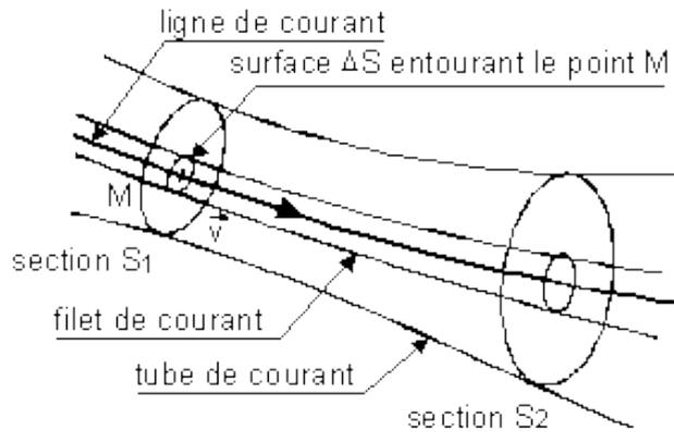
Fig.II.3 Tube de courant.
