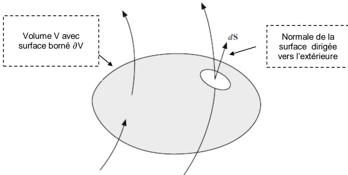
Fig. I.1 Conservation de la masse dans le volume matériel de fluide de masse  $m$
