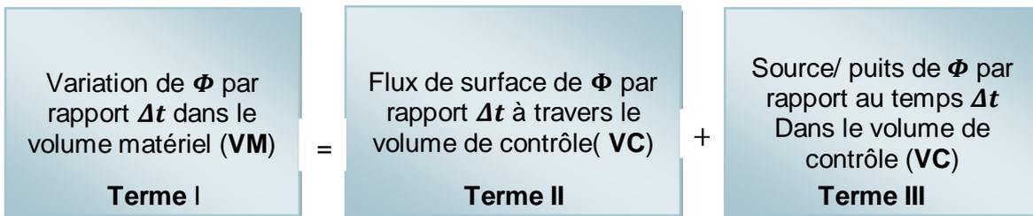
Pour un **volume de contrôle fixe**, le changement de  $\Phi$  en fonction du temps dans le volume de matériel peut être écrit en utilisant le théorème de transport de Reynolds comme suit :
