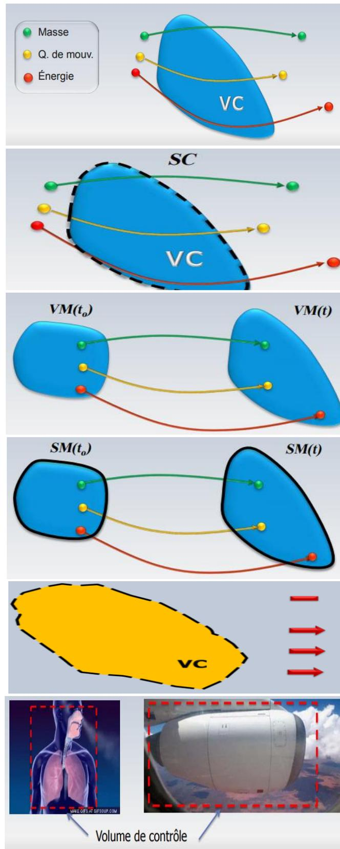
Bien que fréquemment le volume de contrôle (**VC**) est fixe, il peut aussi être en mouvement ou se déformer.
