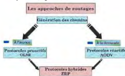
Figure 2 : Différentes familles de protocoles dans les réseaux ad hoc
