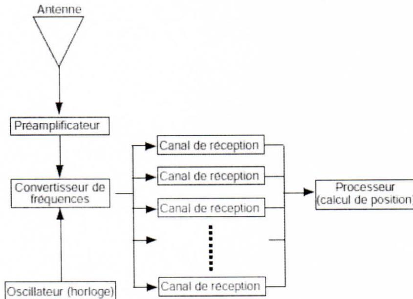
Cette figure représente le schéma de fonctionnement des récepteurs GPS et Galileo
